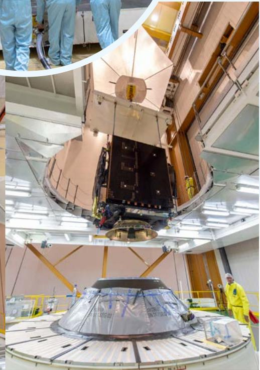
EDRS-C nähert sich am Kran hängend langsam der Raketenoberstufe
