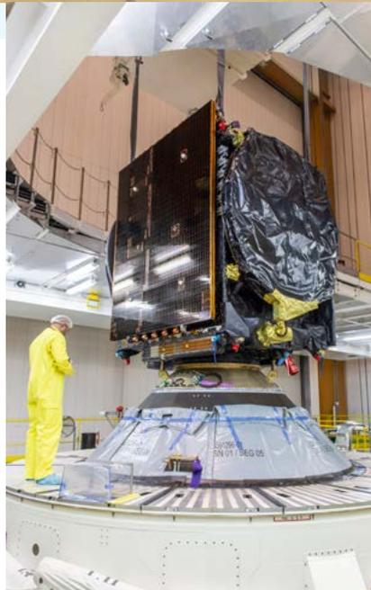
EDRS-C ist auf dem Adaptersystem der Raketenoberstufe montiert
