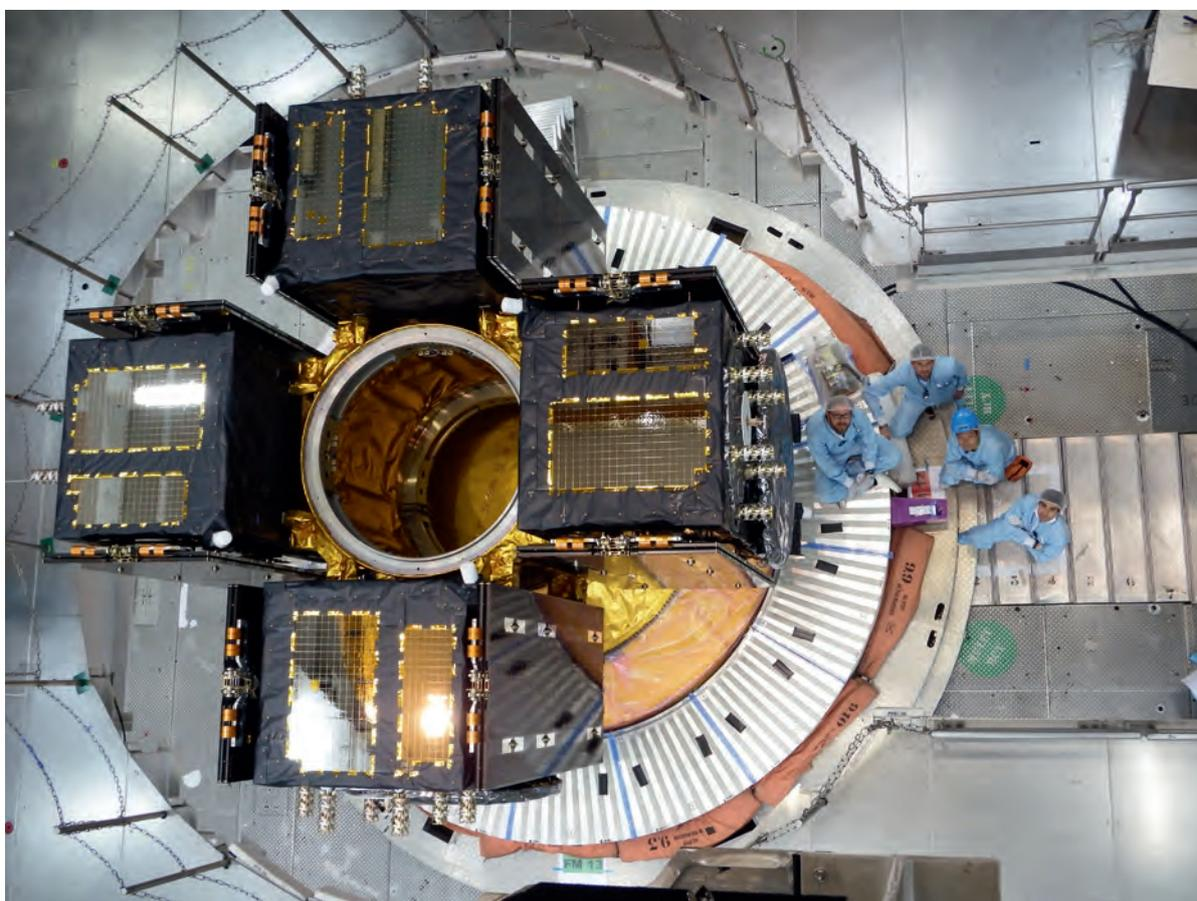
OHB Team mit den 4 Galileo-FOC\*-Satelliten nach Beendigung der letzten Abschlussarbeiten an den Satelliten (z.B. Armierung und Entfernung letzter Protektoren) im Finalen Montage-Gebäude A5 (BAF)
