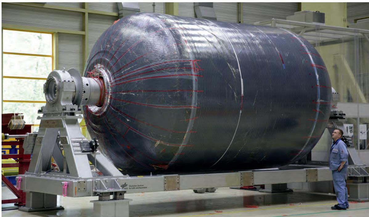
Im Rahmen einer Zusammenarbeit zwischen dem DLR und MT Aerospace hergestellter Booster aus carbonfaserverstärktem Kunststoff (CFK)
