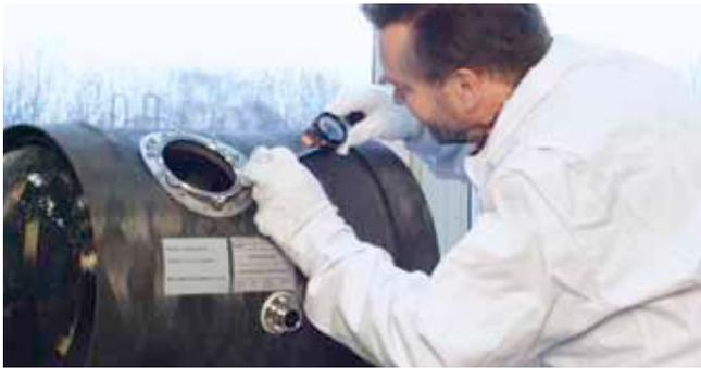
Qualitätsprüfung eines Wassertanks bei MT Aerospace
