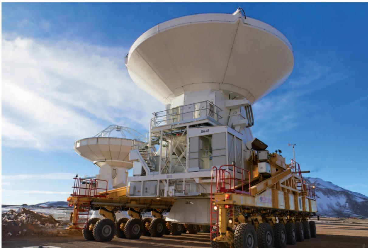
Die erste europäische Antenne für das Atacama Large Millimeter/Submillimeter Array (ALMA) in Chile ist auf dem Chajnantor Plateau in 5.000 m Höhe angekommen.
