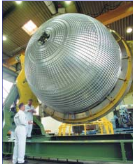
Bauteil für die Flüssig-Wasserstoff-Tanks der Oberstufe der Ariane 5
