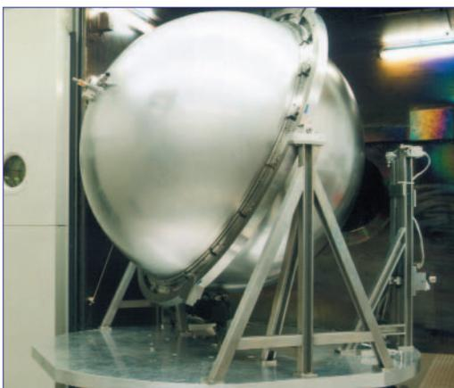
Treibstofftank für das Automated Transfer Vehicle (ATV)
