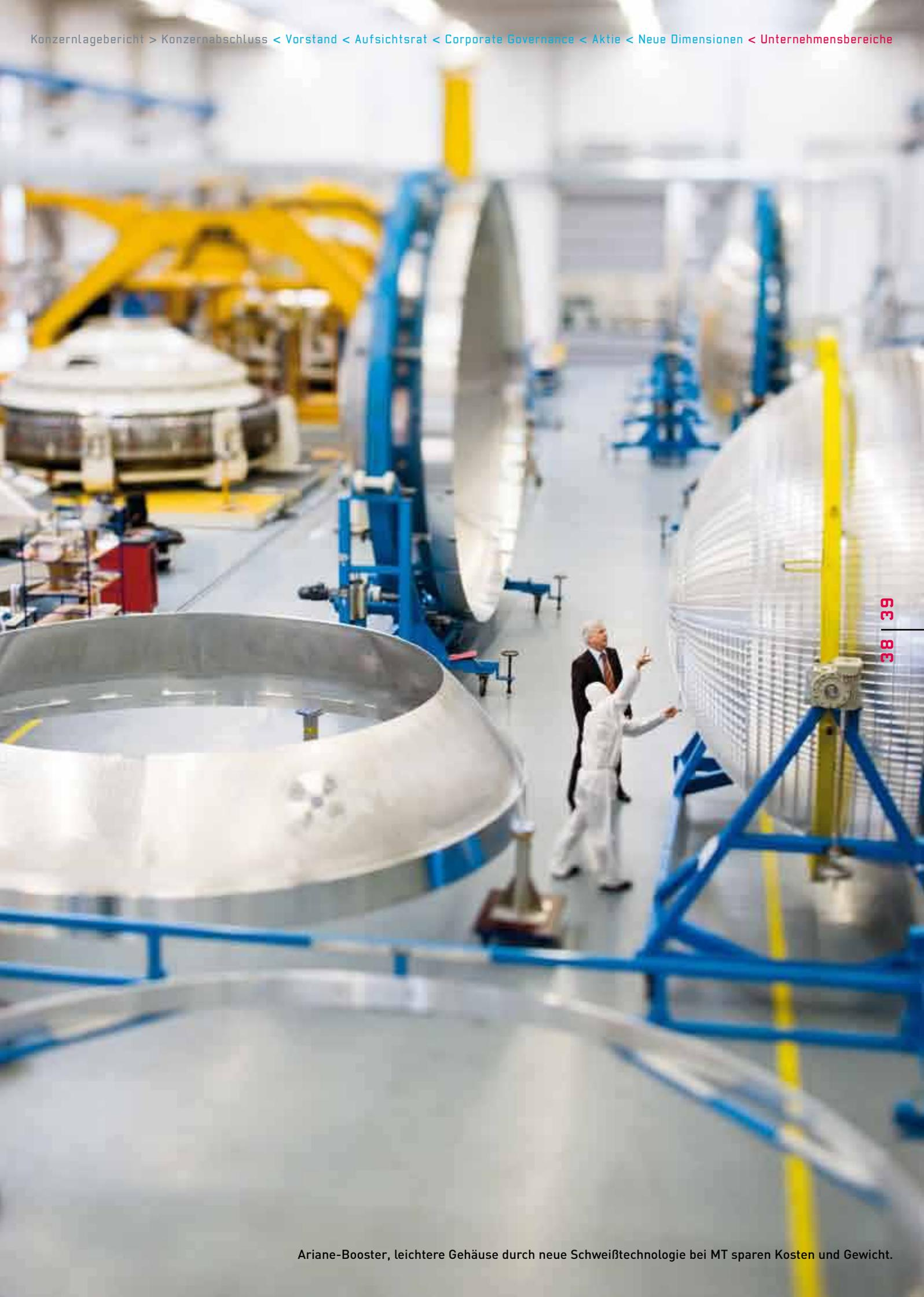
Ariane-Booster, leichtere Gehäuse durch neue Schweißtechnologie bei MT sparen Kosten und Gewicht.
