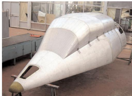
*COSMOS Fairing: Für die Starts der SAR-Lupe-Satelliten musste die Nutzlastverkleidung der COSMOS-Rakete angepasst werden. Ein Referenzflug mit verändertem Fairing erfolgt Anfang 2005.*
